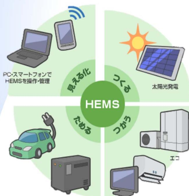
HEMSを導入した時のメリットは、大きく分けて『見える化』と『自動制御』の2種類になります。
